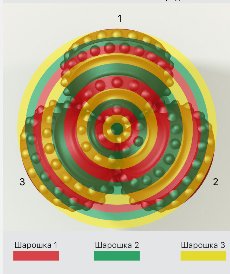
Рис. 8. Схема скалывания породы
