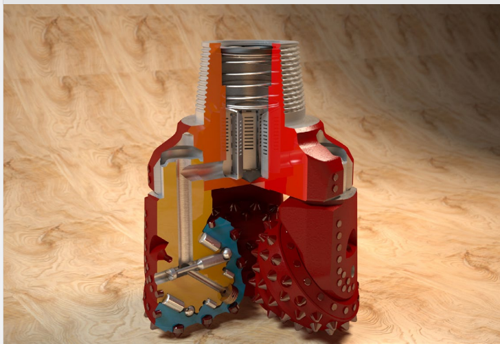
Рис. 3. Схема продувки подшипников
